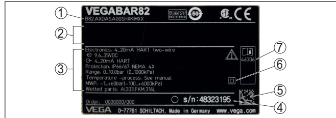
Abb. 1: Aufbau des Typschildes (Beispiel)
