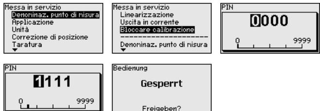
3. Sbloccare nuovamente la calibrazione inserendo nuovamente il PIN del sensore
