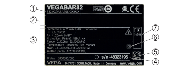
Fig. 1: Opbouw van de typeplaat (voorbeeld)
