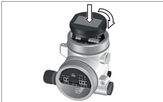
Fig. 6: Plaatsen van de display- en bedieningsmodule
