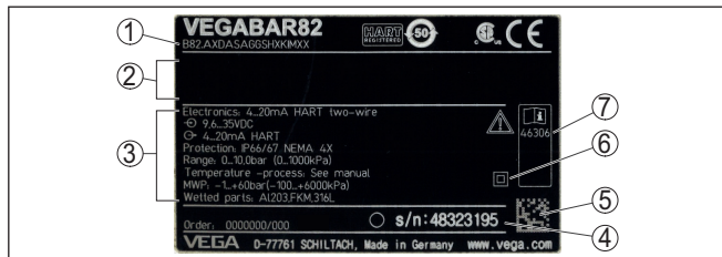
Fig. 1: Opbouw van de typeplaat (voorbeeld)
