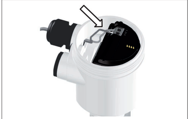
Fig. 2: Aansluitstappen 5 en 6 - eenkamerbehuizingen
