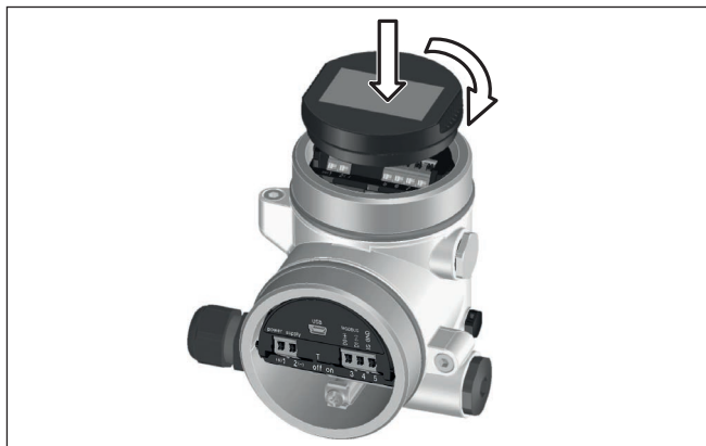
Figura 6: Inserzione del tastierino di taratura con display
