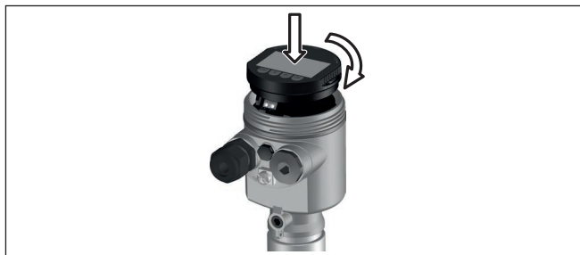
Figura 5: Inserimento del tastierino di taratura con display nel vano dell'elettronica in caso di custodia ad una camera
