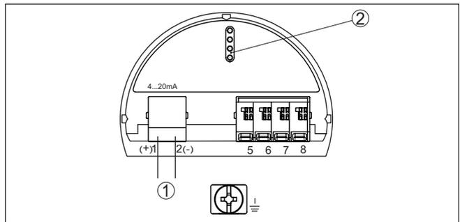
Abb. 4: Elektronikraum - Zweikammergehäuse
