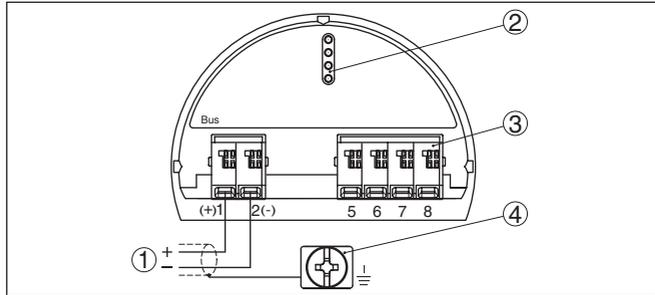
Abb. 6: Anschlussraum - Zweikammergehäuse
