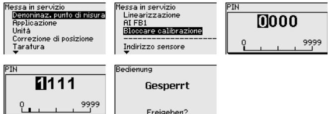
3. Sbloccare la calibrazione inserendo nuovamente il PIN del sensore
