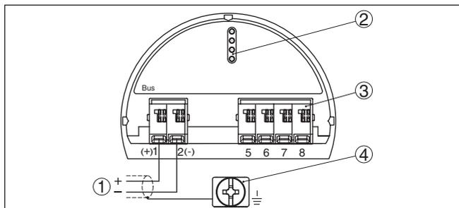
Figura 6: Vano di allacciamento - custodia a due camere
