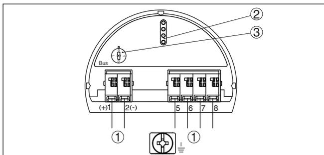
Figura 5: Vano dell'elettronica - custodia a due camere
