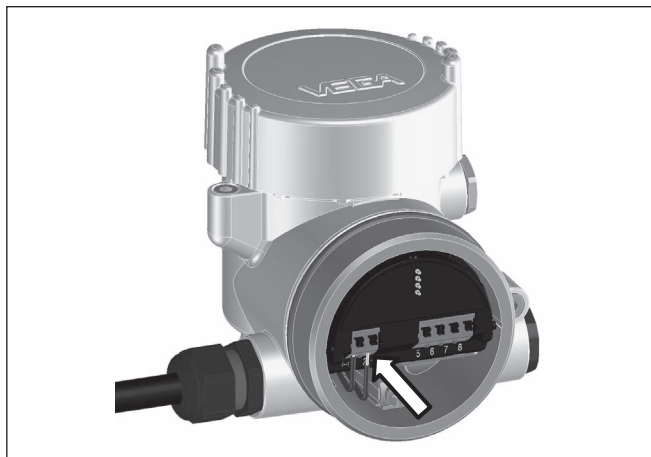
Figura 3: Operazioni di collegamento 5 e 6
