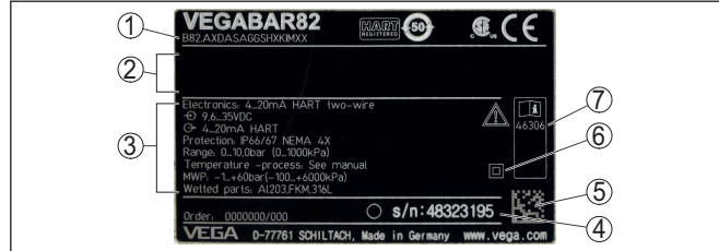
Abb. 1: Aufbau des Typschildes (Beispiel)
