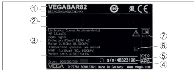
Fig. 1: Opbouw van de typeplaat (voorbeeld)
