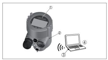
Abb. 46: Anschluss des PCs via Bluetooth-Adapter
