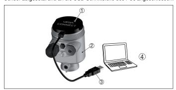
Abb. 44: Anschluss des PCs via VEGACONNECT und USB
