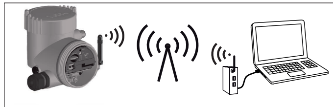
Rys. 33: Transmisja bezprzewodowa wartości pomiarowych i zdalne wprowadzanie parametrów do przyrządu za pośrednictwem sieci bezprzewodowej GSM
