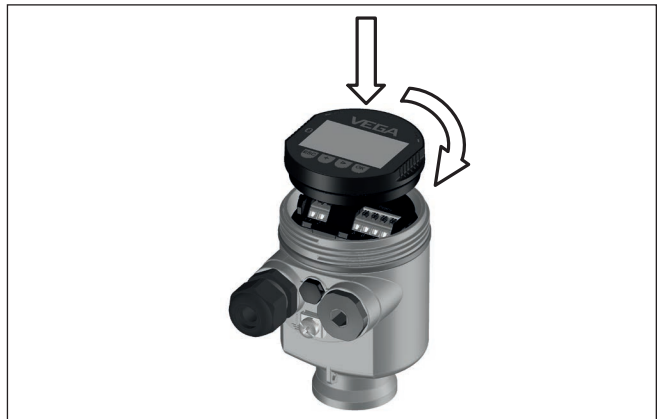
Abb. 6: Einsetzen des Anzeige- und Bedienmoduls beim Einkammergehäuse im Elektronikraum
