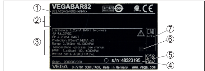
Abb. 1: Aufbau des Typschildes (Beispiel)
