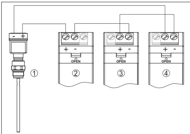
Fig. 2: Exemple de raccordement en fonctionnement mixte actif/passif
