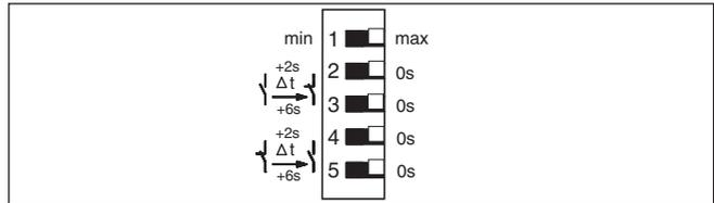
Fig. 4: Commutateur DIL VEGATOR 141
