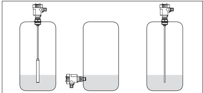
Fig. 5: Exemples d'application avec capteur 4 ... 20 mA (capteur de pression ou sonde de mesure capacitive à tige)
