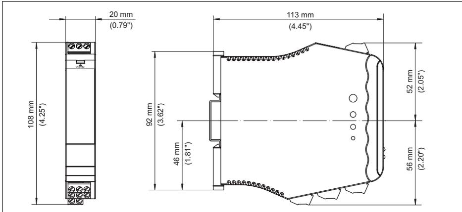
Fig. 9: Encombrement VEGATOR 141
