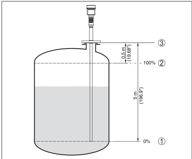
Abb. 7: Parametrierbeispiel Min.-/Max.-Abgleich
