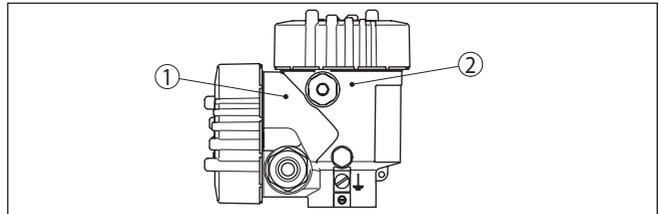
Abb. 3: Position von Anschlussraum (Modbuselektronik) und Elektronikraum (Sensorelektronik)
