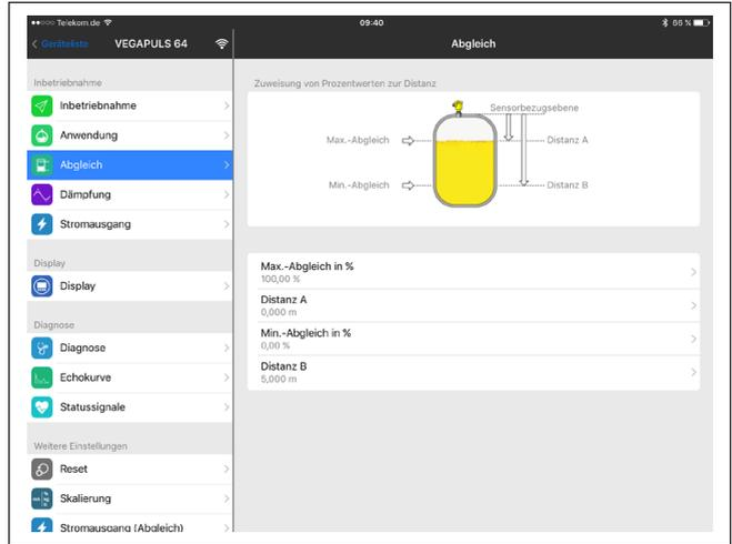
Abb. 9: Beispiel einer App-Ansicht - Inbetriebnahme Sensorabgleich
