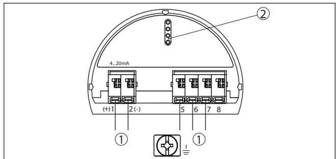
Abb. 4: Elektronikraum - Zweikammergehäuse
