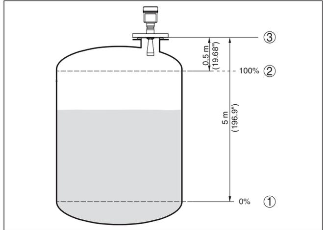
Abb. 10: Parametrierbeispiel Min./Max.-Abgleich
