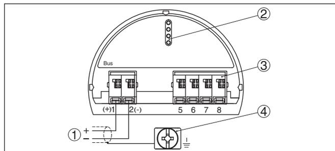
Abb. 7: Anschlussraum - Zweikammergehäuse
