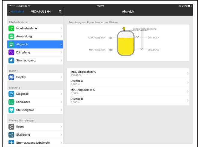
Abb. 12: Beispiel einer App-Ansicht - Inbetriebnahme Sensorabgleich
