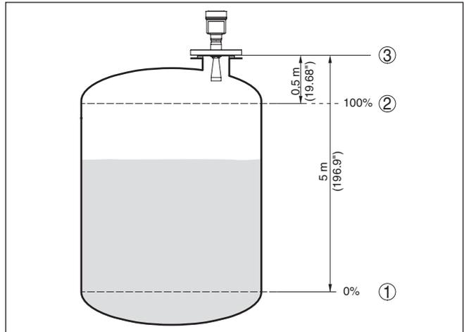
Abb. 7: Parametrierbeispiel Min.-/Max.-Abgleich
