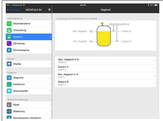
Abb. 8: Beispiel einer App-Ansicht - Inbetriebnahme Sensorabgleich
