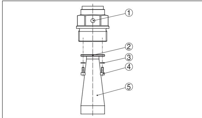
Abb. 3: Demontage der Hornantenne
