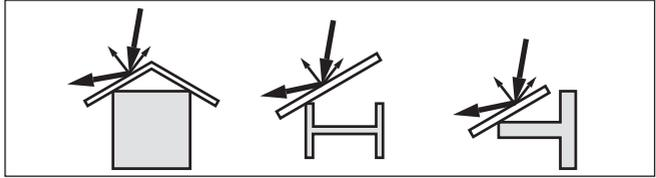
Fig. 21: Recouvrir les obstacles lisses par des déflecteurs
