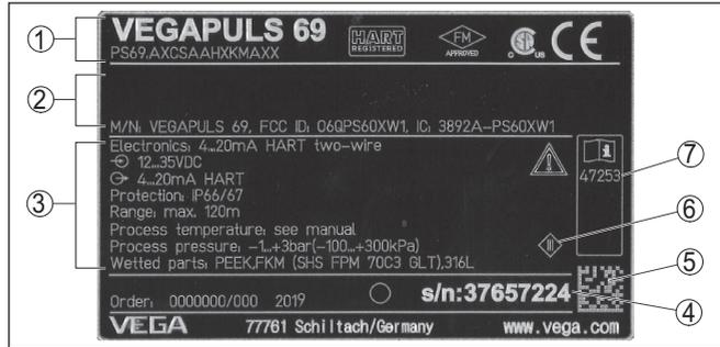
Fig. 1: Estructura de la placa de tipos (ejemplo)
