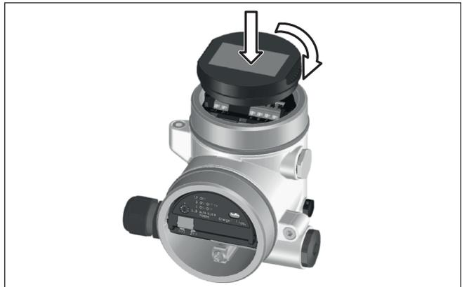
Abb. 9: Einsetzen des Anzeige- und Bedienmoduls
