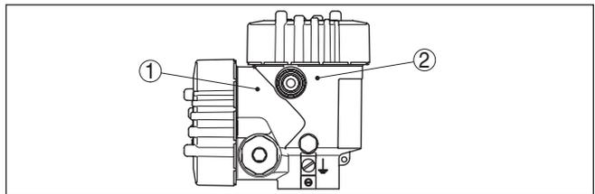
Abb. 6: Position von Versorgungs- und Elektronikraum
