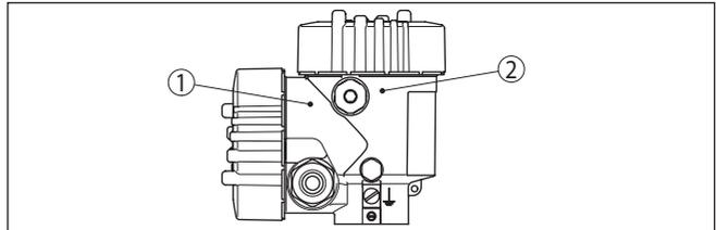
Abb. 7: Position von Anschlussraum (Modbuselektronik) und Elektronikraum (Sensorelektronik)
