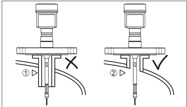
Fig. 6: Monter la rehausse de façon arasante
