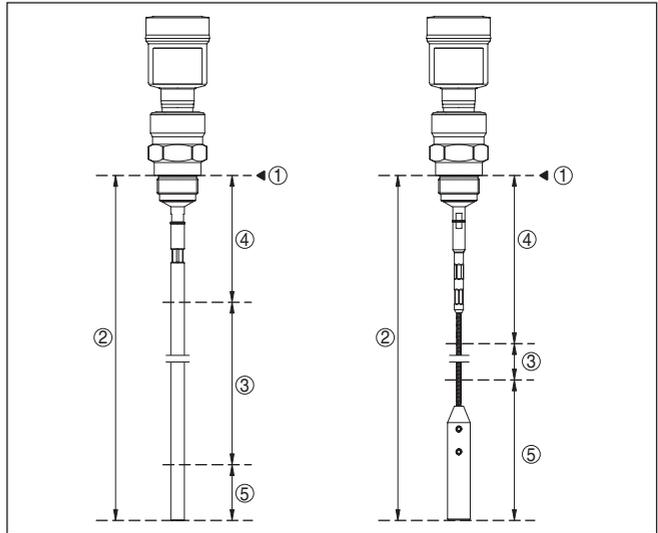
Fig. 12: Plages de mesure - VEGAFLEX 82
