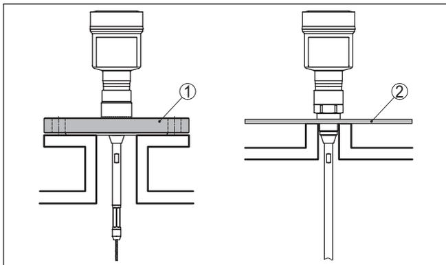
Fig. 3: Montage dans des cuves non métalliques
