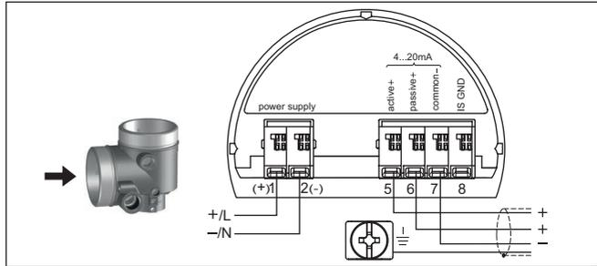
Abb. 8: Anschlussraum Zweikammergehäuse bei Klein-
