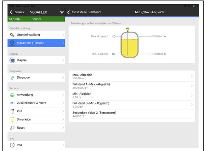
Abb. 11: Beispiel einer App-Ansicht - Inbetriebnahme Sensorabgleich
