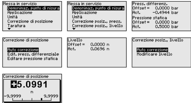
Per la correzione automatica di posizione si assume l'attuale valore di misura come valore di correzione. Questo valore non deve essere falsificato a causa di immersione nel prodotto o pressione statica.
