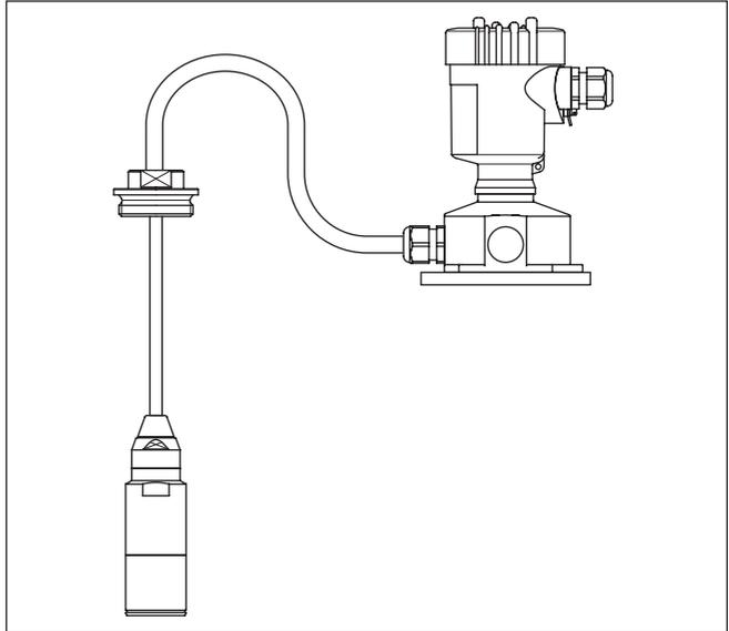
Abb. 17: VEGABAR 86 in IP68-Ausführung 25 bar, nicht-Ex und axialem Kabelabgang, externes Gehäuse
