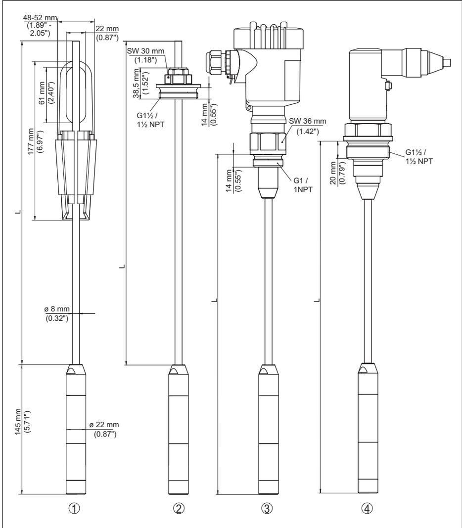
Abb. 31: VEGABAR 86, Messwertaufnehmer 22 mm
