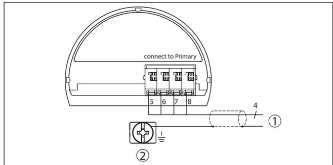
Abb. 16: Anschlussplan VEGABAR 86 Secondary Device
