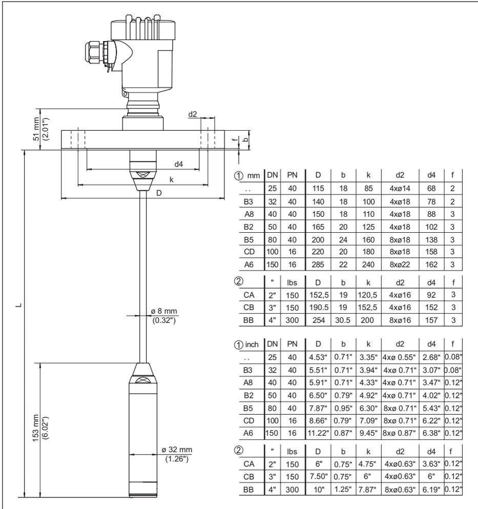
Abb. 33: VEGABAR 86, Flanschanschluss (Beispiel: Messwertaufnehmer 32 mm)
