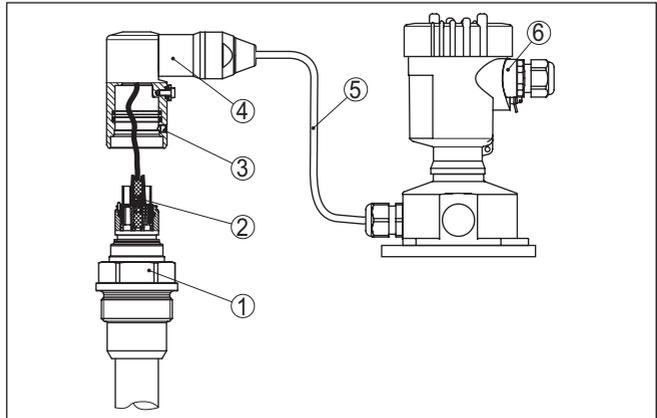
Abb. 23: VEGABAR 86 in IP68-Ausführung 25 bar und seitlichem Kabelabgang, externes Gehäuse
