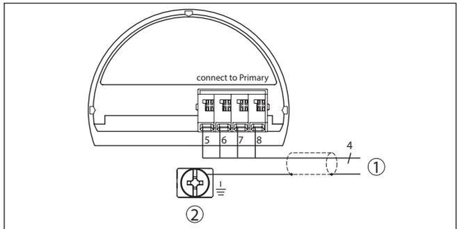
Abb. 20: Anschlussplan VEGABAR 86 Secondary Device
