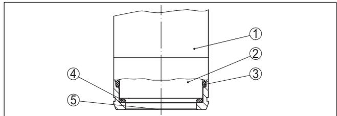
Abb. 4: Frontbündiger Einbau der keramischen Messzelle mit Doppeldichtung
