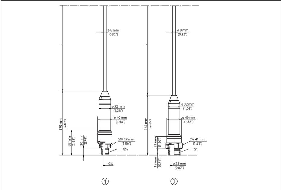
Abb. 35: VEGABAR 86, Gewindeausführung
