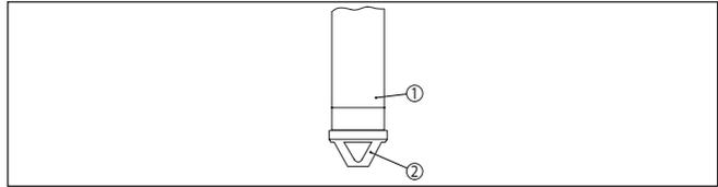
Abb. 6: VEGABAR 86, Transport- und Montageschutz
