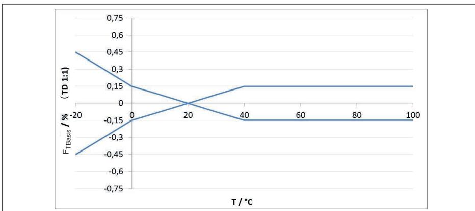
Abb. 25: Basis-Temperaturfehler  $F_{TBasis}$  bei TD 1 : 1
