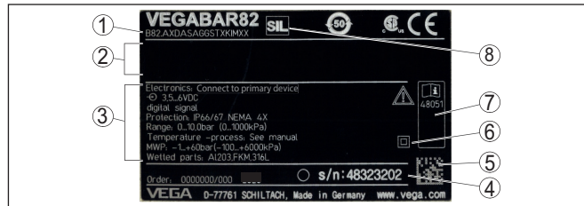
Abb. 1: Aufbau des Typschildes (Beispiel)
