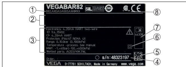
Fig. 1: Opbouw van de typeplaat (voorbeeld)
