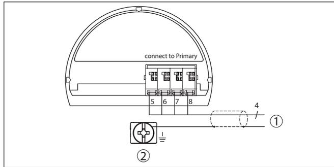
Fig. 3: Esquema de conexiones VEGABAR 82 dispositivo secundario
