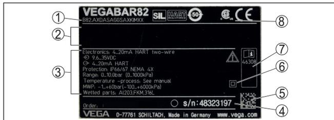
Figura 1: Struttura della targhetta d'identificazione (esempio)
