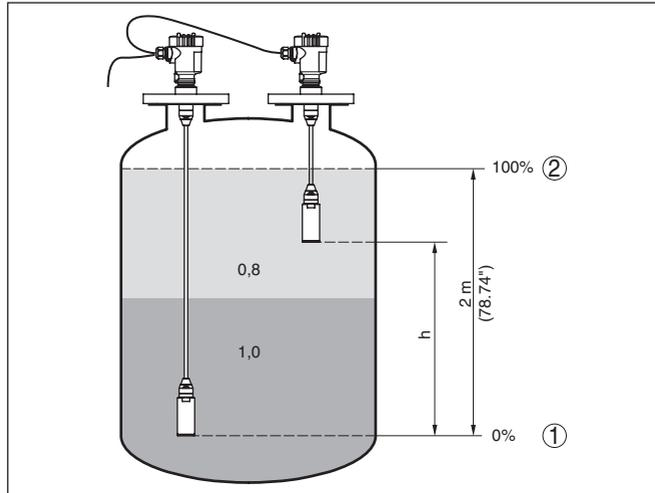
Figura 8: Esempio di parametrizzazione taratura di min./max. per misura d'interfaccia
