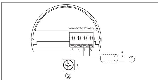
Figura 4: Schema di collegamento VEGABAR 86 secondary device
