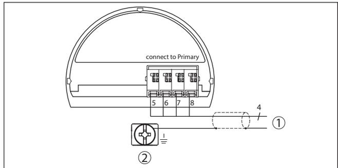
Figura 4: Schema di collegamento VEGABAR 87 secondary device
