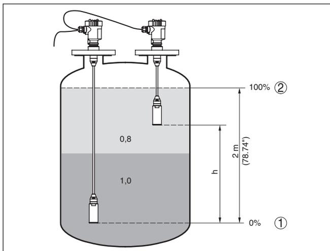
Figura 8: Esempio di parametrizzazione taratura di min./max. per misura d'interfaccia
