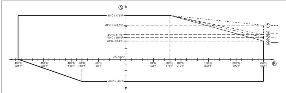
Abb. 28: Umgebungstemperatur - Prozesstemperatur, Standardausführung
