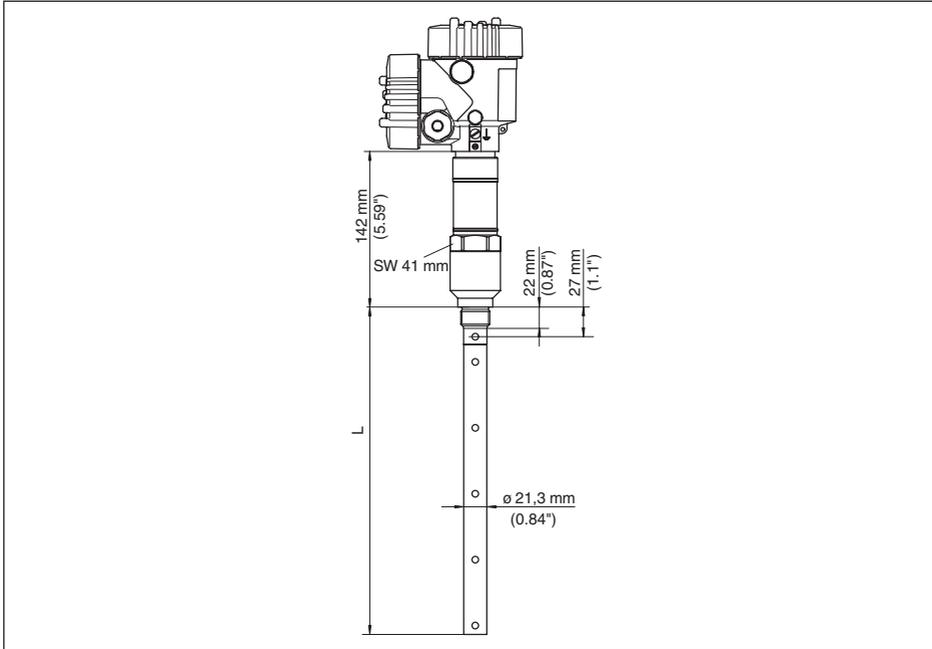
Abb. 30: VEGAFLEX 86, Koaxialausführung mit Gewinde (-20 ... +250 °C/-4 ... +482 °F)
