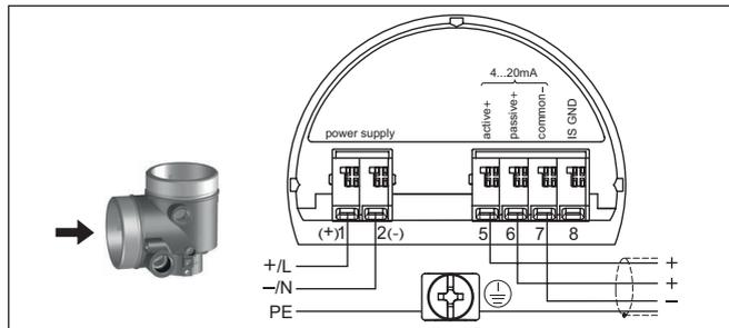
Abb. 10: Anschlussraum Zweikammergehäuse bei Netzspannung
