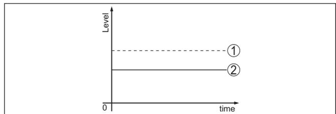
Abb. 22: Die gestrichelte Linie 1 zeigt den tatsächlichen Füllstand, die durchgezogene Linie 2 zeigt den vom Sensor angezeigten Füllstand
