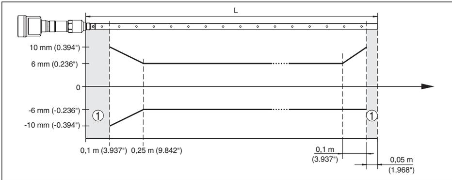
Abb. 27: Messabweichung VEGAFLEX 86 in Koaxialausführung in Medium Öl (Messlänge bis 6 m/19.69 ft)
