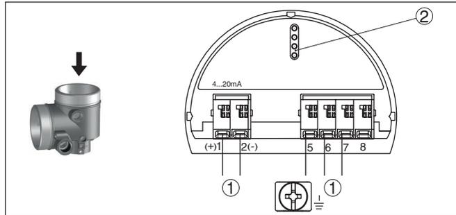
Abb. 9: Elektronikraum - Zweikammergehäuse
