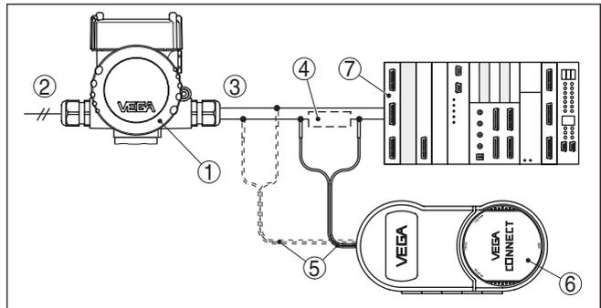
Abb. 18: Anschluss des PCs via HART an die Signalleitung
