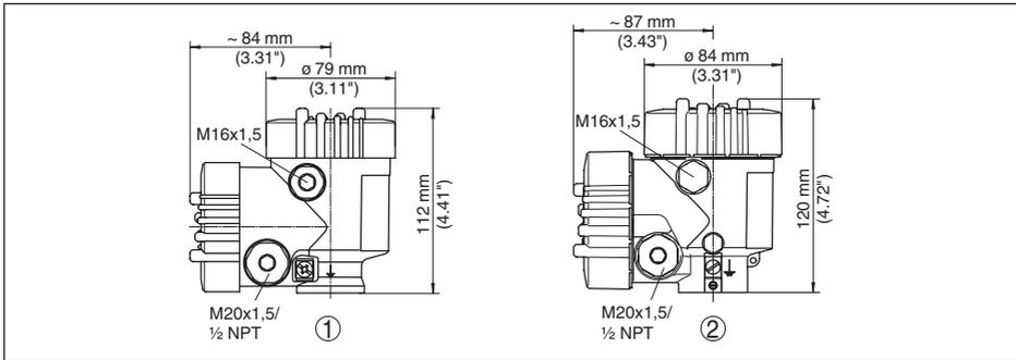
Abb. 29: Maße Gehäuse (mit eingebautem Anzeige- und Bedienmodul vergrößert sich die Gehäusehöhe um 9 mm/0.35 in)
