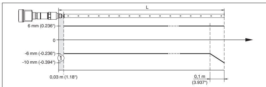
Fig. 25: Meetafwijking VEGAFLEX 86 in coaxuitvoering in product water (meetlengte tot 6 m/19.69 ft)
