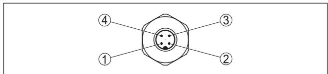
Abb. 15: Sicht auf den M12 x 1-Steckverbinder
