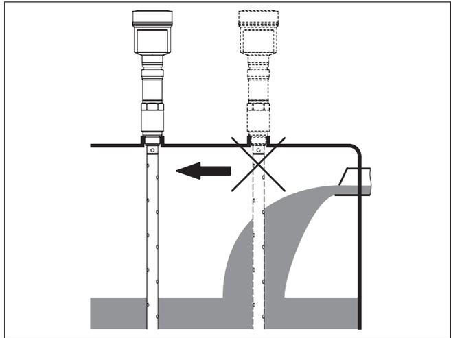
Abb. 5: Montage des Sensors bei einströmendem Medium
