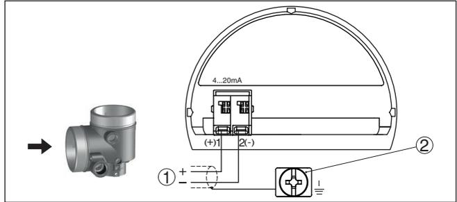
Abb. 13: Anschlussraum - Ex-d-ia-Zweikammergehäuse
