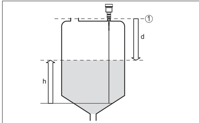
Abb. 2: Füllstandmessung
