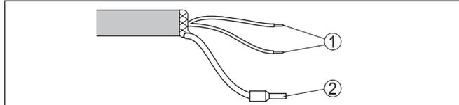
Abb. 16: Aderbelegung fest angeschlossenes Anschlusskabel
