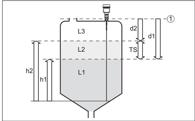
Abb. 3: Trennschichtmessung
