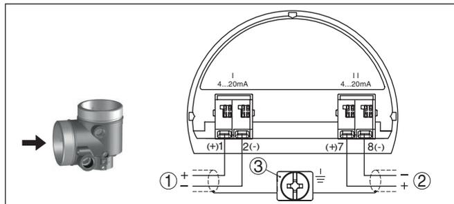
Abb. 17: Anschlussraum Zweikammergehäuse, Zusatzelektronik - Zusätzlicher Stromausgang
