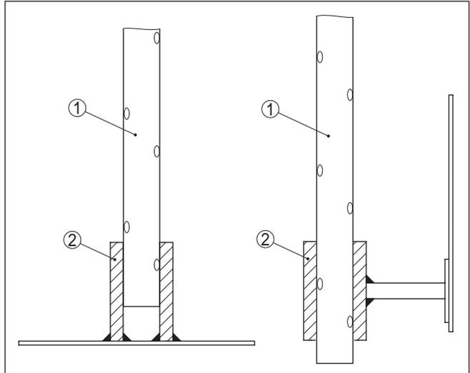
Abb. 6: Messsonde fixieren
