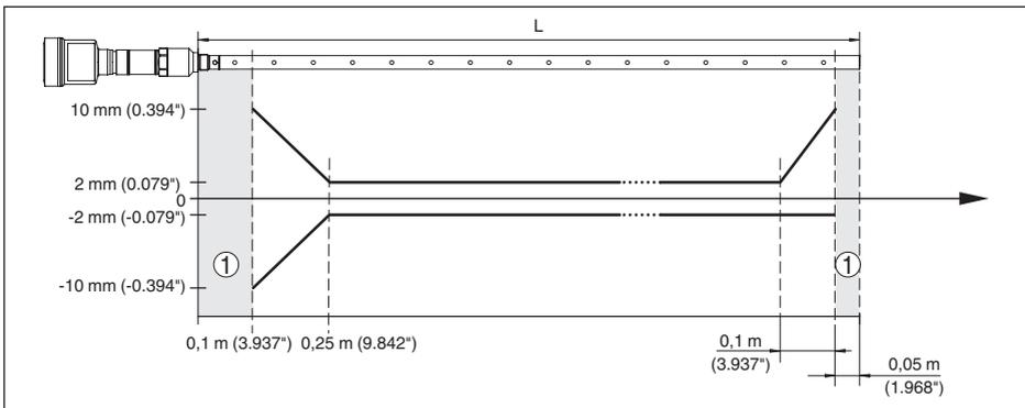
Abb. 30: Messabweichung VEGAFLEX 86 in Koaxialausführung in Medium Öl (Messlänge bis 1,5 m/4.92 ft)
