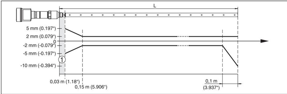
Abb. 28: Messabweichung VEGAFLEX 86 in Koaxialausführung in Medium Wasser (Messlänge bis 1,5 m/4.92 ft)
