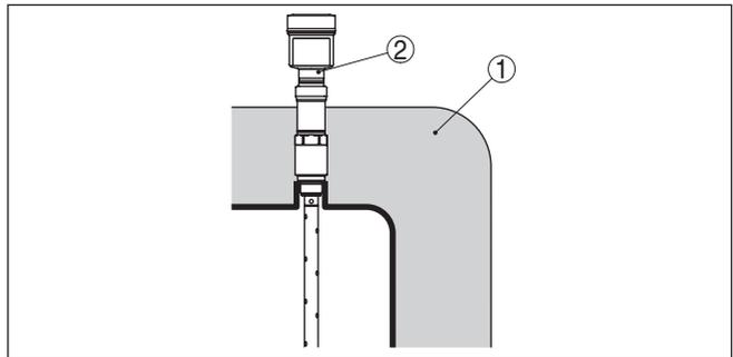
Abb. 7: Montage des Gerätes bei isolierten Behältern.
