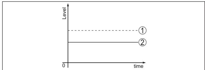
Abb. 26: Die gestrichelte Linie 1 zeigt den tatsächlichen Füllstand, die durchgezogene Linie 2 zeigt den vom Sensor angezeigten Füllstand
