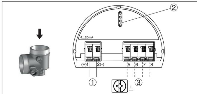
Abb. 12: Elektronikraum - Zweikammergehäuse
