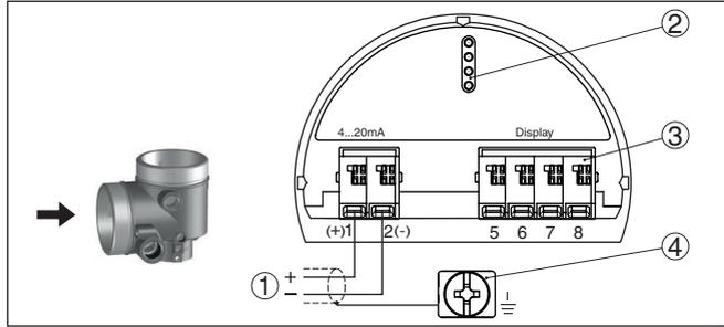
Abb. 11: Anschlussraum - Zweikammergehäuse
