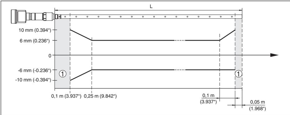
Abb. 31: Messabweichung VEGAFLEX 86 in Koaxialausführung in Medium Öl (Messlänge bis 6 m/19.69 ft)
