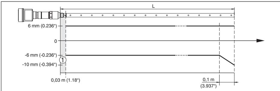
Abb. 29: Messabweichung VEGAFLEX 86 in Koaxialausführung in Medium Wasser (Messlänge bis 6 m/19.69 ft)
