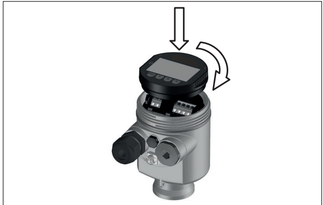
Abb. 24: Einsetzen des Anzeige- und Bedienmoduls beim Einkammergehäuse im Elektronikraum
