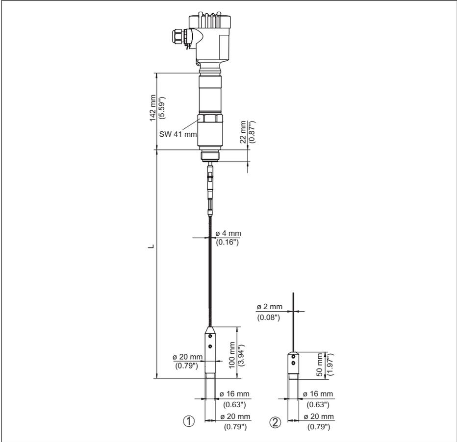
Abb. 49: VEGAFLEX 86, Gewindeausführung mit Straffgewicht (alle Straffgewichte mit Gewinde M8 für Ringschraube)
