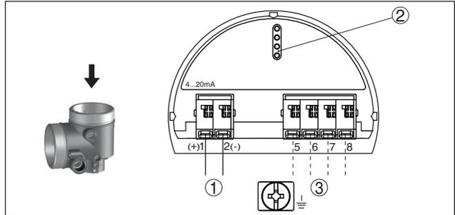
Abb. 19: Elektronikraum - Ex-d-ia-Zweikammergehäuse
