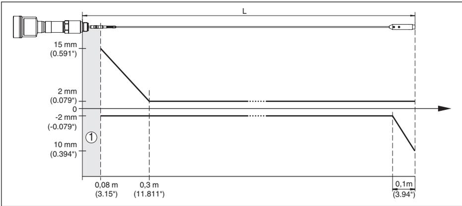
Abb. 40: Messabweichung VEGAFLEX 86 in Seilausführung in Medium Wasser
