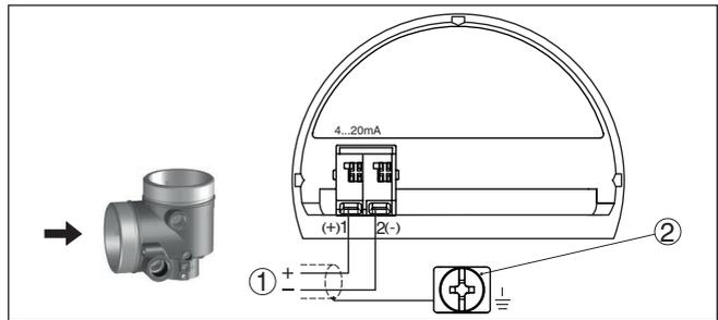
Abb. 20: Anschlussraum - Ex-d-ia-Zweikammergehäuse
