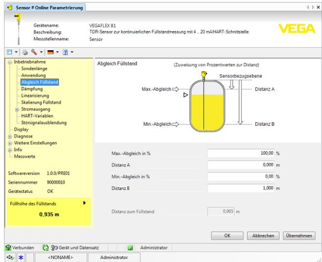
Abb. 31: Beispiel einer DTM-Ansicht
