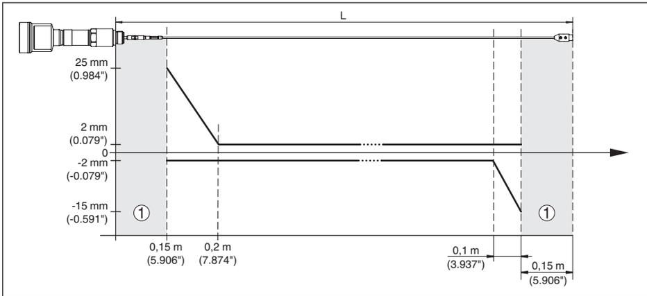
Abb. 42: Messabweichung VEGAFLEX 86 in Seilausführung (4 mm/0.157 in), in Medium Öl
