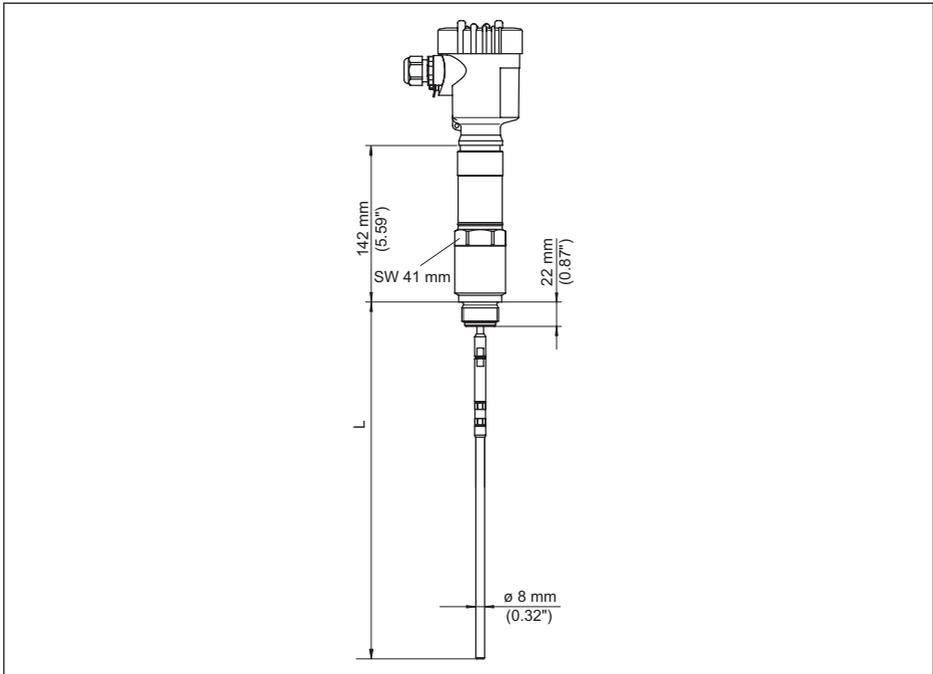
Abb. 51: VEGAFLEX 86, Gewindeausführung
