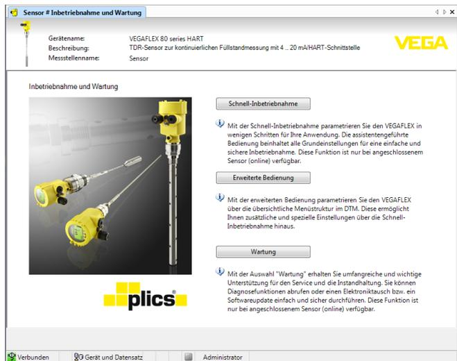
Abb. 32: Schnellinbetriebnahme auswählen
