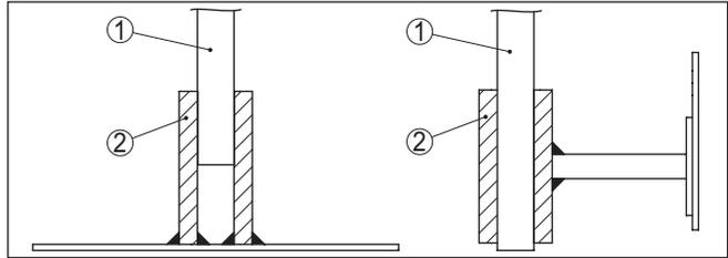
Abb. 12: Messsonde fixieren
