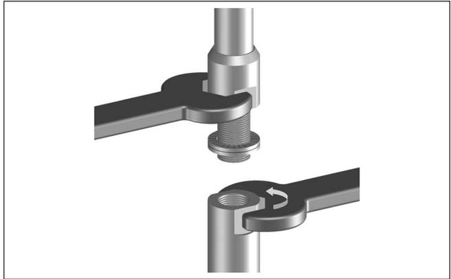
Abb. 35: Messseil bzw. Messstab wechseln
