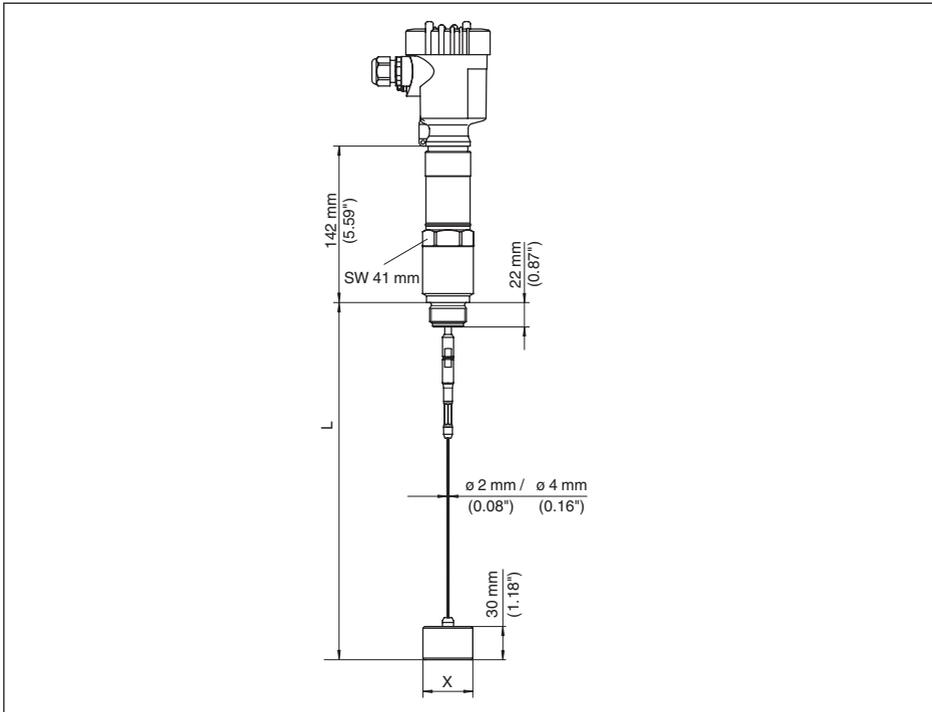
Abb. 50: VEGAFLEX 86, Gewindeausführung mit Zentriergewicht
