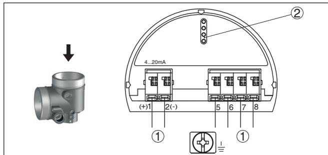
Abb. 16: Elektronikraum - Zweikammergehäuse
