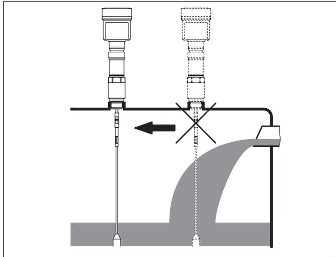
Abb. 8: Montage des Sensors bei einströmendem Medium
