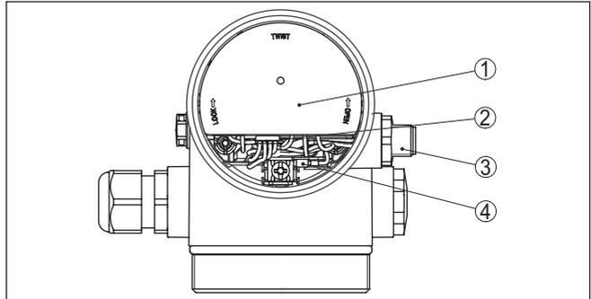
Abb. 21: Sicht auf den Elektronikraum mit VEGADIS-Adapter zum Anschluss der externen Anzeige- und Bedieneinheit
