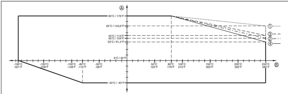
Abb. 43: Umgebungstemperatur - Prozesstemperatur, Standardausführung
