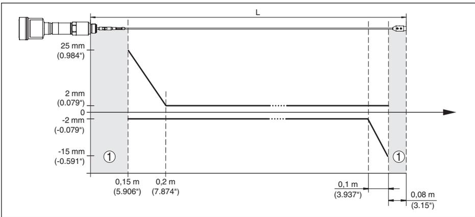
Abb. 41: Messabweichung VEGAFLEX 86 in Seilausführung (2 mm/0.079 in), in Medium Öl
