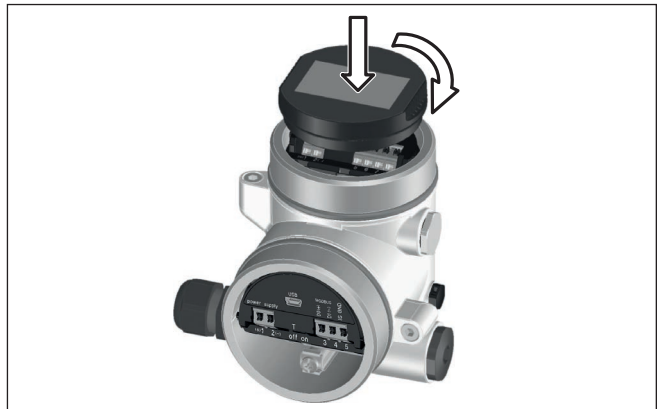
Fig. 6: Plaatsen van de display- en bedieningsmodule
