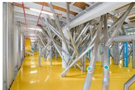
Der Rohrboden dient dazu, die Zwischenprodukte den Walzenstühlen zuzuführen. Jeder Prozessschritt wird während der Verarbeitung erfasst.
