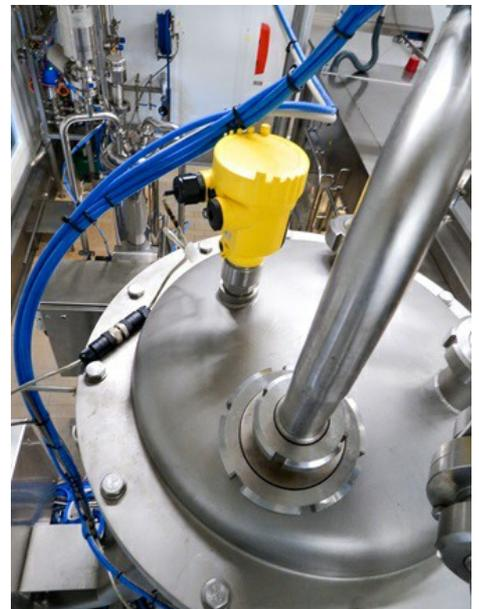
用VEGA传感器来控制液位，以确保酸奶的罐装能够顺利进行。
