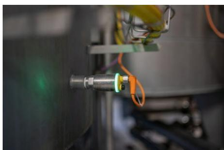
À différentes étapes du process de brassage, les seuils de niveau jouent aussi un rôle déterminant : chez Alpirsbacher, le détecteur de niveau VEGAPOINT est par exemple utilisé dans le concasseur de malt. Cette machine broie le malt avant le brassage. Le détecteur de niveau signale immédiatement qu'un niveau défini est atteint. De cette manière, il est possible d'éviter tout débordement du concasseur ou une marche à vide qui pourrait entraîner des dommages à long terme.
