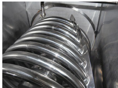
De groente wordt verhit in een trog-gaarder met een roterende verwarmingsspiraal, waarin een VEGAPULS 64 het vulniveau continu bewaakt.
