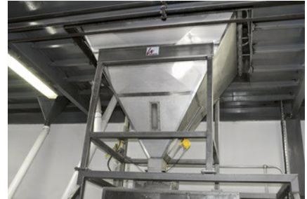
Het niveau in de droogvoertank wordt nu betrouwbaar gemeten en kan constant worden gehouden.
