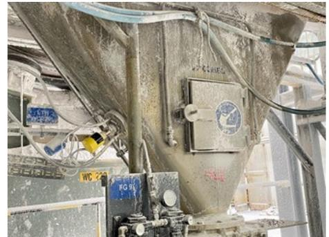
Der VEGACAP 65 auf einem Aufnahmetrichter: Selbst von starken Pulver-Anhaftungen, die sich rund um Sensor bilden, bleibt die Messung unbeeinflusst.
