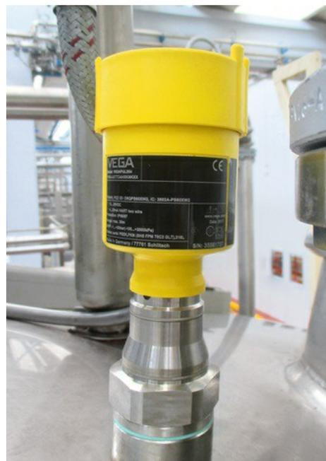
Le VEGAPULS 64 mesure avec fiabilité malgré les dépôts colmatants – dans ce cas, du chocolat – et une situation de montage difficile (présence d'un agitateur).
