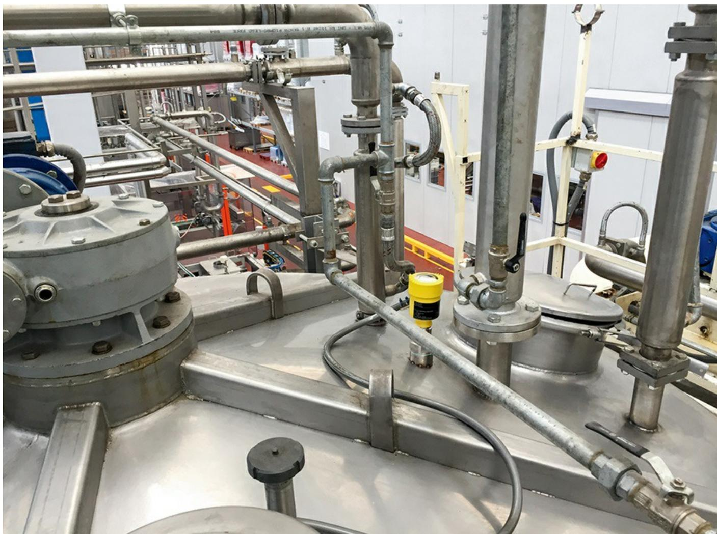
Le capteur mesure le niveau avec une grande précision, aussi bien à proximité du couvercle de la cuve que près du fond. En outre, le VEGAPULS 64 ne nécessite aucune maintenance.
