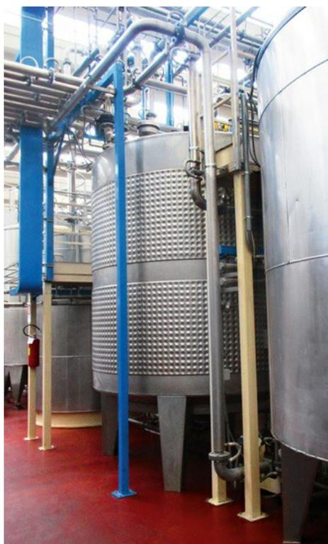
Le capteur de niveau radar mesure le chocolat liquide dans les cuves de 5 m de haut.
